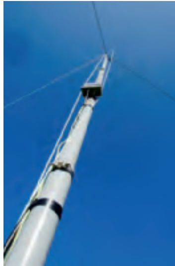
Antenna var en endefødet halvbølge for 80 til 10 meter, opphengt på to bardunerte glassfibermaster.
